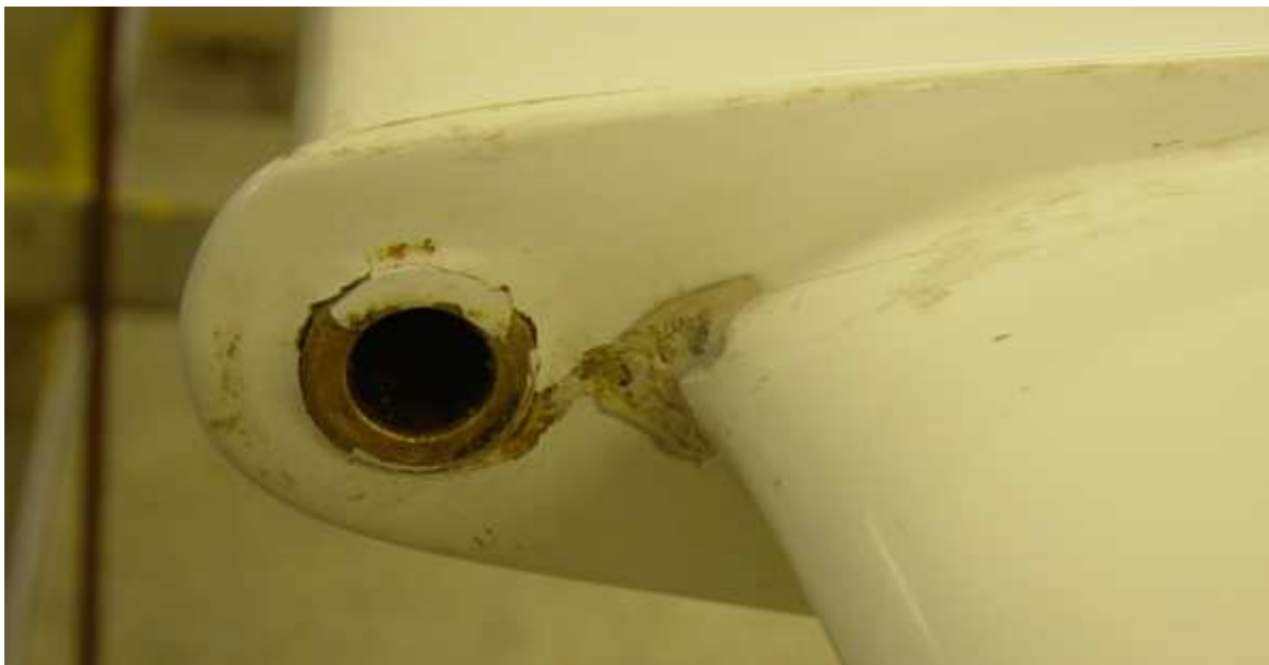
Możliwa postać uszkodzenie węzła mocowania usterzenia
